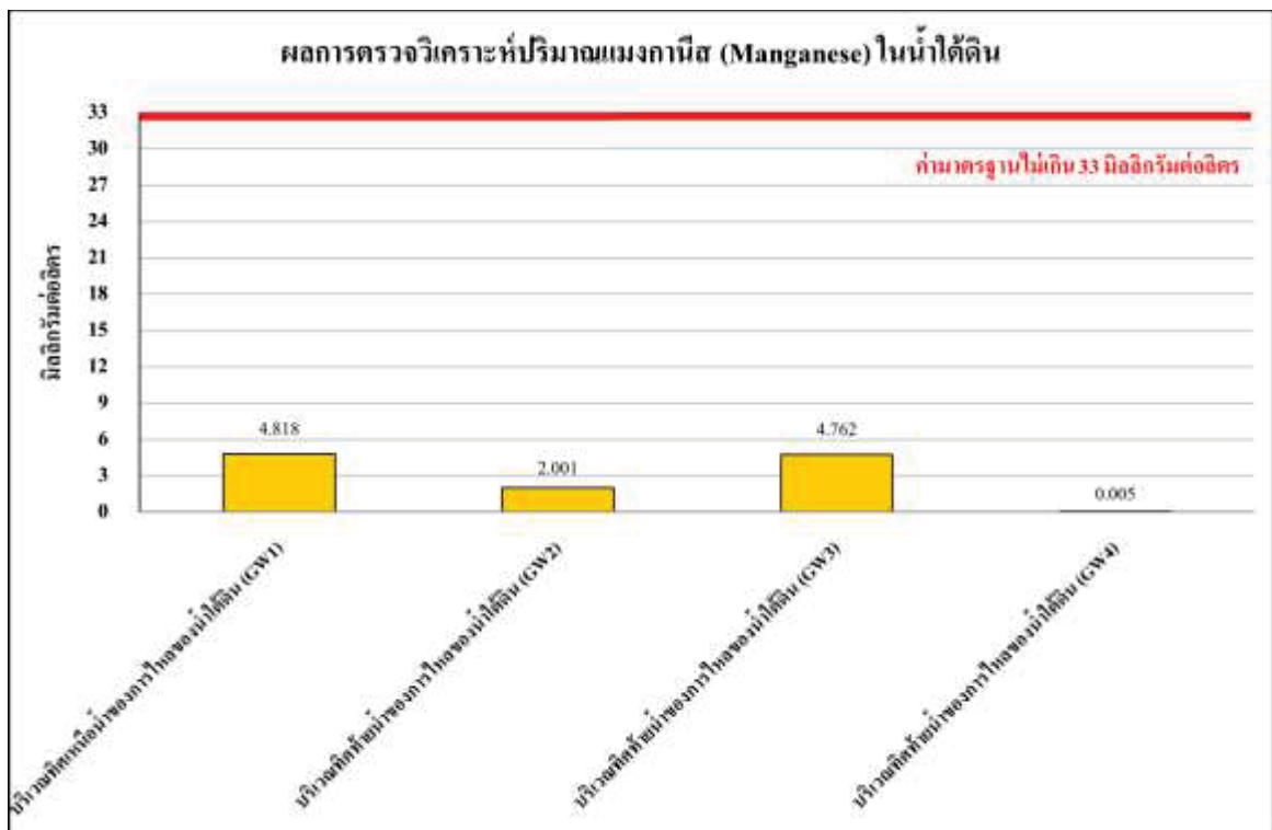
รูปที่ 4.4.3-4 ผลการตรวจวิเคราะห์ปริมาณแมงกานีส (Manganese) ในน้ำใต้ดิน ตรวจวิเคราะห์วันที่ 28 สิงหาคม 2567
