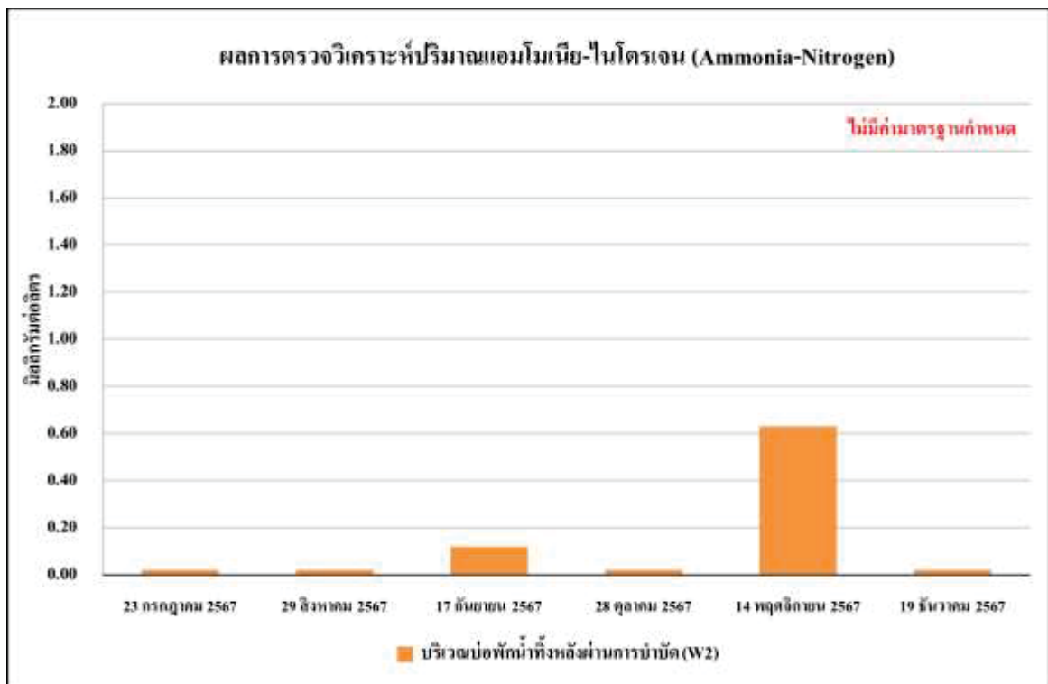
รูปที่ 4.4.2-8 ผลการตรวจวิเคราะห์ปริมาณแอมโมเนีย-ไนโตรเจน (Ammonia-Nitrogen) ของบ่อบำบัดน้ำทิ้งหลังผ่านการบำบัด (W2) ระหว่างเดือนกรกฎาคม-ธันวาคม 2567
