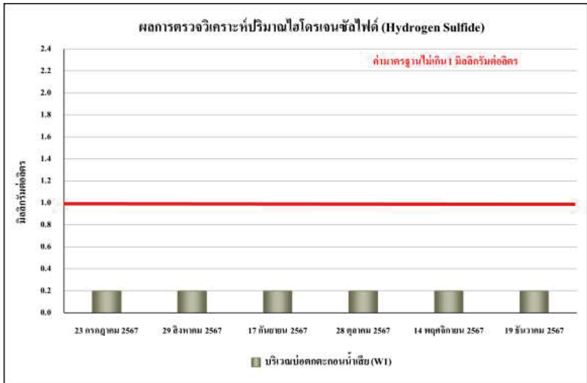
รูปที่ 4.4.2-9 ผลการตรวจวิเคราะห์ปริมาณไฮโดรเจนซัลไฟด์ (Hydrogen Sulfide) ของบ่อดักตะกอนน้ำเสีย (W1) ระหว่างเดือนกรกฎาคม-ธันวาคม 2567
