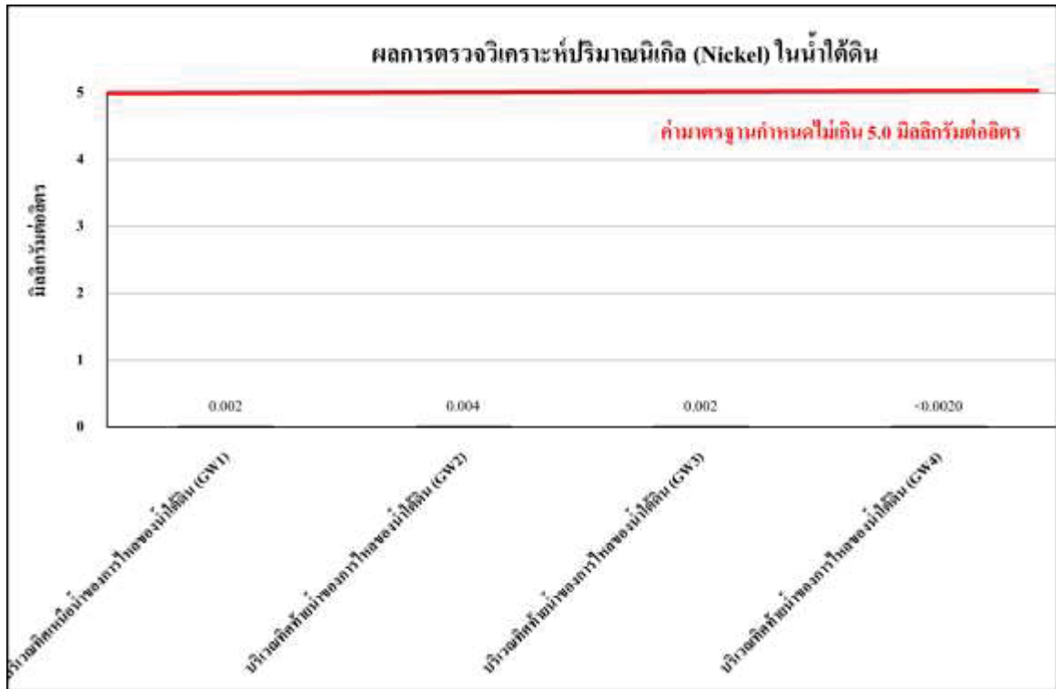
รูปที่ 4.4.3-7 ผลการตรวจวิเคราะห์ปริมาณนิกเกิล (Nickel) ในน้ำใต้ดิน ตรวจวิเคราะห์วันที่ 28 สิงหาคม 2567
